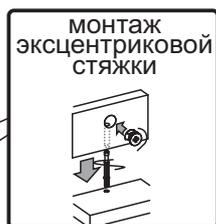
**5.** Установите собранную конструкцию на боковины №1, №2. Закрепите крышку №3 эксцентриковыми стяжками.
