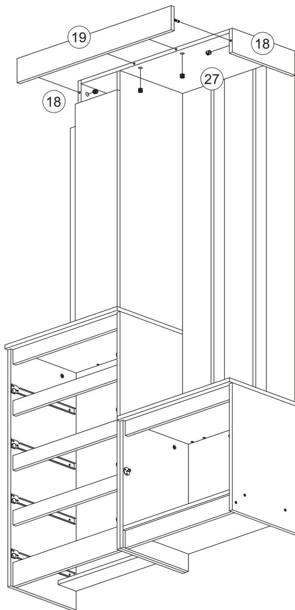
13. Соедините профилем №30 задние стенки №15, профилем №31 задние стенки №28 и прибейте их гвоздями.
