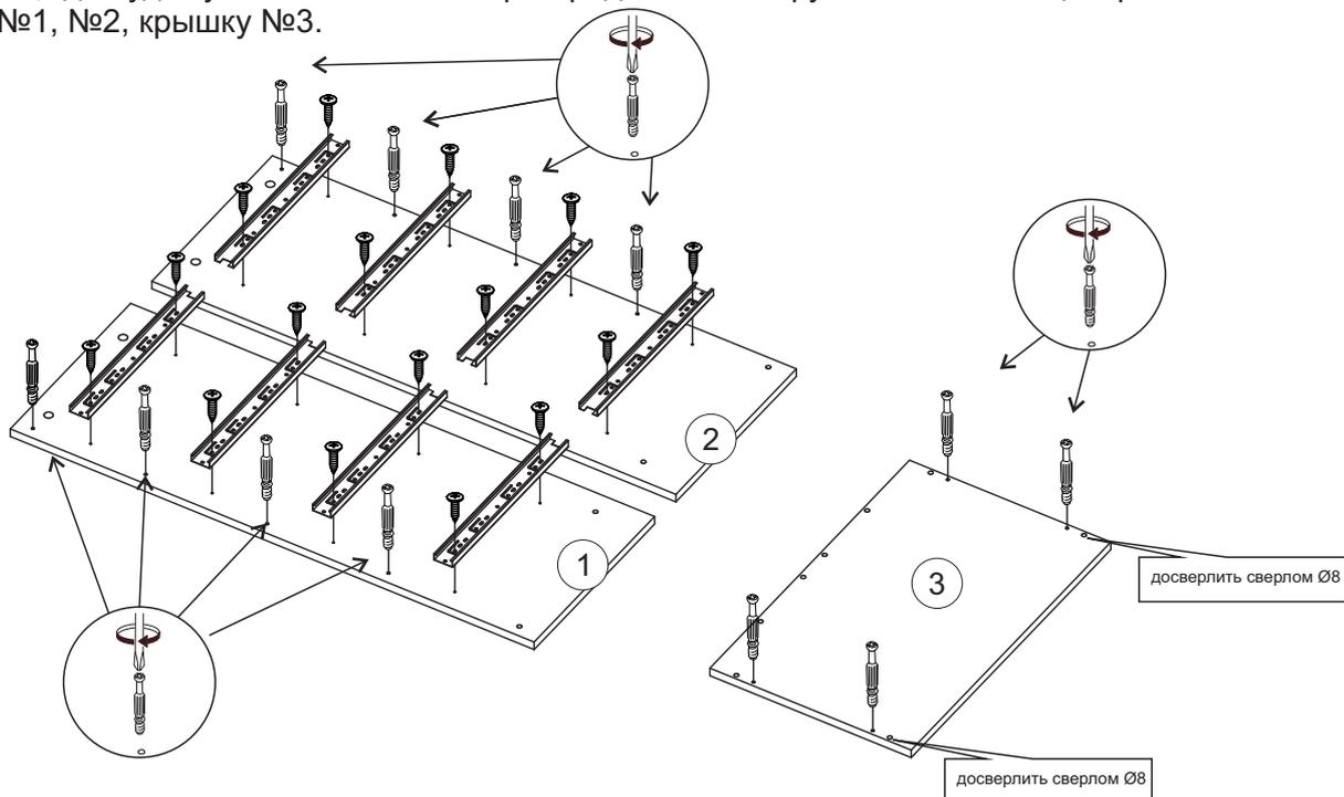
3. Соберите корпус тумбы с зеркалом. Для этого сначала эксцентриковыми стяжками соедините планки №16 с боковинами №1, №2. Затем евровинтами соедините цоколя №4 с боковинами №1, №2.
