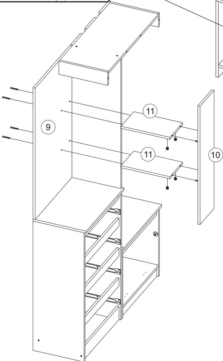
**11.** Соедините вязки №11 с задней стенкой №9 евровинтами, а с панелью №10 эксцентриковыми стяжками.
