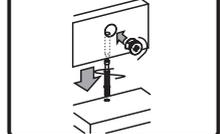
12. Соедините панель №19 с вязкой №27, панелями №18 используя эксцентрикивые стяжки.
