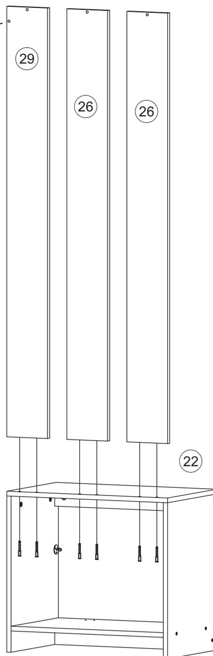
9. Соедините евровинтами задние стенки №26, №29 с крышкой №22, с учетом того, что задняя стенка №29 имеет отверстие под крепление панели №18.
