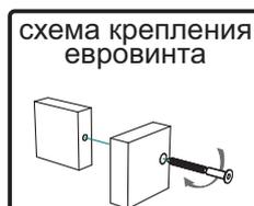
**10.** Сверлом Ø5 просверлите боковины 1/2 и 20/21 для установления межсекционной стяжки. С помощью евровинтов соедините вязку №27 с перегородкой №12, задними стенками №26, №29.
