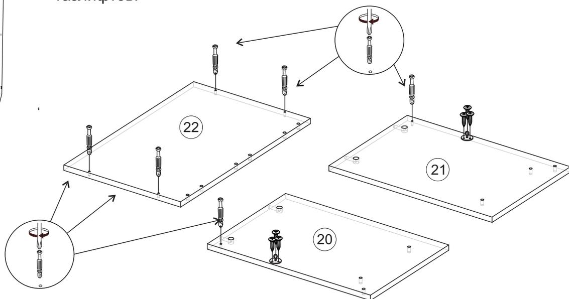
7. Соедините планку №16 с боковинами №20, №21 используя эксцентрики-стяжки. Вязку №23 и цоколь №24 соедините с указанными боковинами евровинтами.
